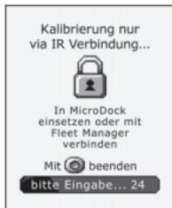
4. Wenn der nebenstehende Bildschirm erscheint, den Prüfgasadapter anbringen und Prüfgas mit einer Durchflussgeschwindigkeit von 250-500 ml/min zuführen. Siehe „Anschließen des Gaszylinders an den Detektor“ auf Seite 8.
